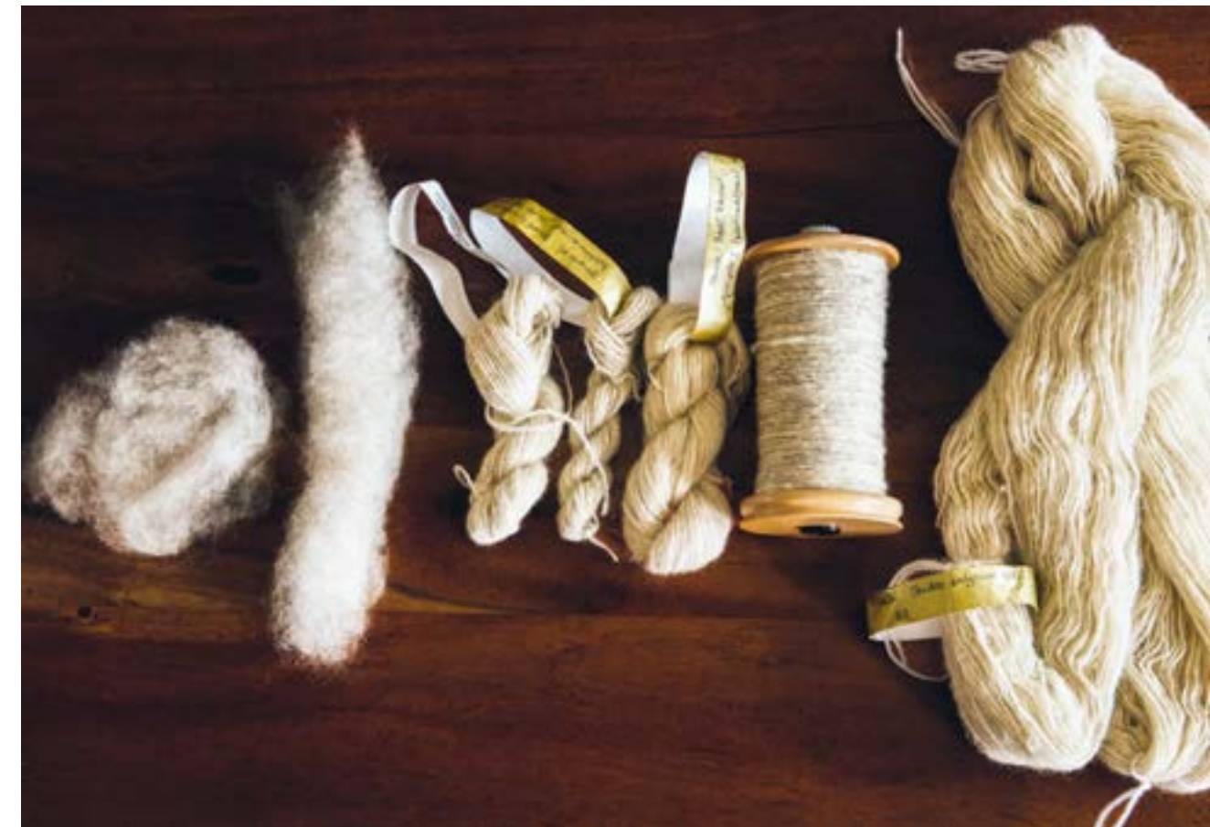
Um das Garn zu stabilisieren, wird maschinell entgrannte Wolle in heißen und kalten Wechselbädern leicht angefilzt.
